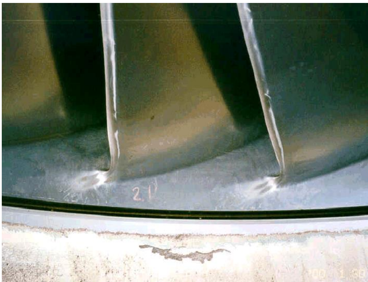
Рисунок 5 – Пример кавитации на ободу рабочего колеса из-за утолщенных лопастей
