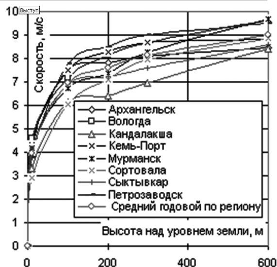
Рис. 8. Среднегодовые высотные профили скорости ветра для севера европейской территории России по данным измерений аэрологических станций региона
