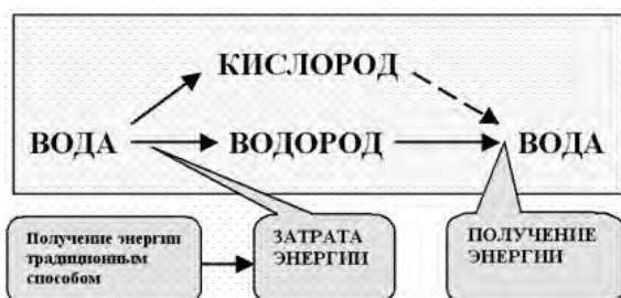
Рис.1. Схема энергопреобразований при получении и сжигании водорода.
