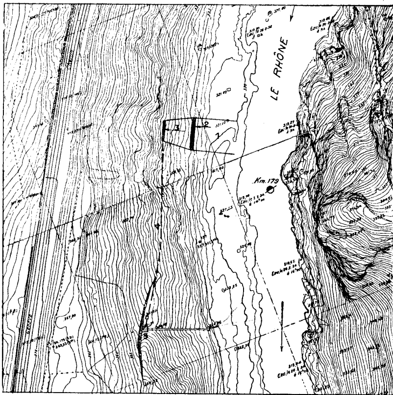
FIG. 9. Plan de situation de la zone d'essais. (1) Zone d'essais. (2) Caniveau de 15 m. de long. (3) Fossé de 10 m. de long. (4) Conduite de 200 Alimentation du fossé. (5) Regard captage eau.
