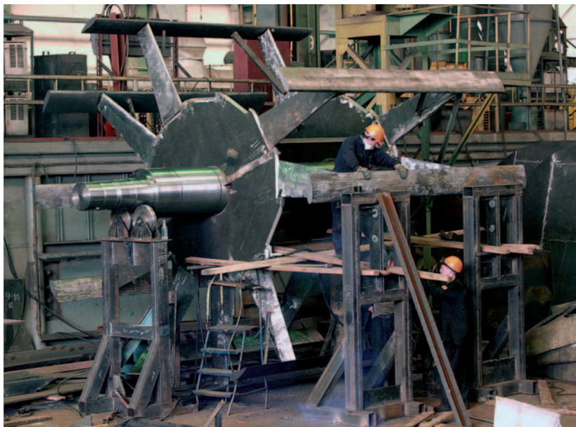
Рис. 5. Рабочее колесо ОГА-5 со стойками и лопастями, изготовленными механическим способом
