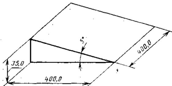
Приспособление представляет собой наклонную плоскость с углом наклона  $5^\circ$ , которое устанавливают на горизонтальной поверхности поверочного стенда или стола. Приспособление может быть изготовлено из любого металла (из алюминия или алюминиевых сплавов). Его собирают из отдельных элементов (пластины и боковых укосин) или отливают в виде полых детали. Наклонную поверхность обрабатывают соответствующим образом для придания ей плоскостности.
