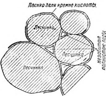
Рис. 239. Уплотненные поры грунта.
