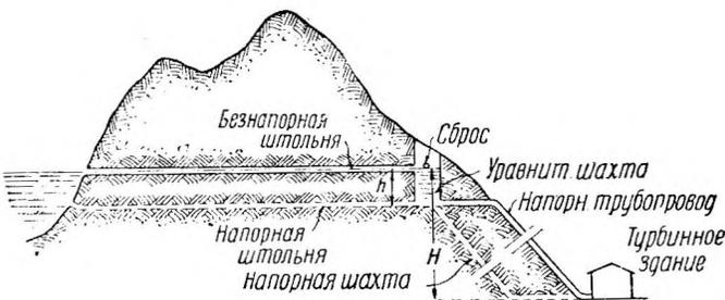
Рис. 4. Схемы деривации гидроустановок.
