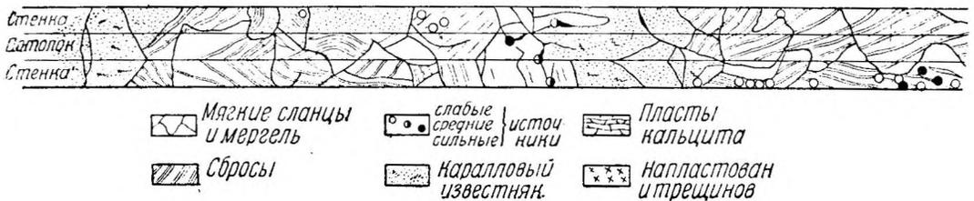
Рис. 29. Геологическая разведка направляющей штольни Шаглерзее
