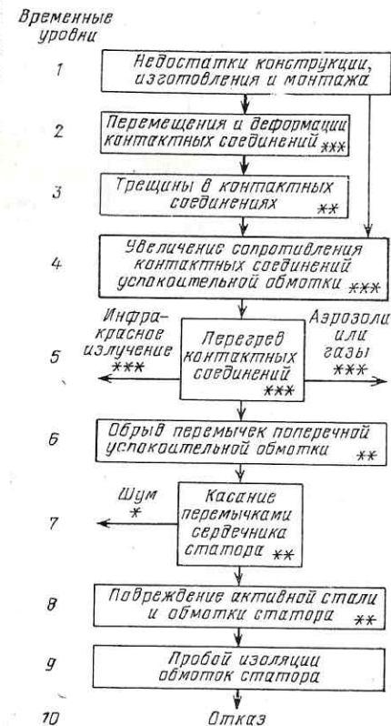
Рис. 5.8. Схема возникновения и развития увеличения сопротивления контактных соединений успокоительной обмотки (обозначения см. на рис. 1.2)
