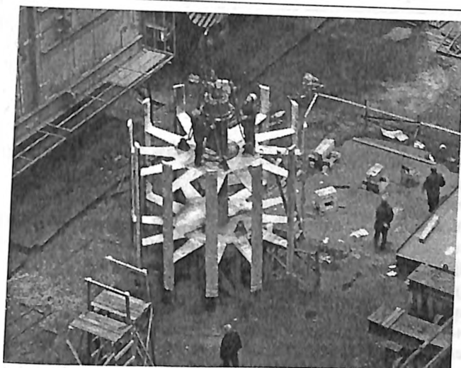
Рис. 5. Рабочее колесо ортогонального гидроагрегата диаметром 5 м.
