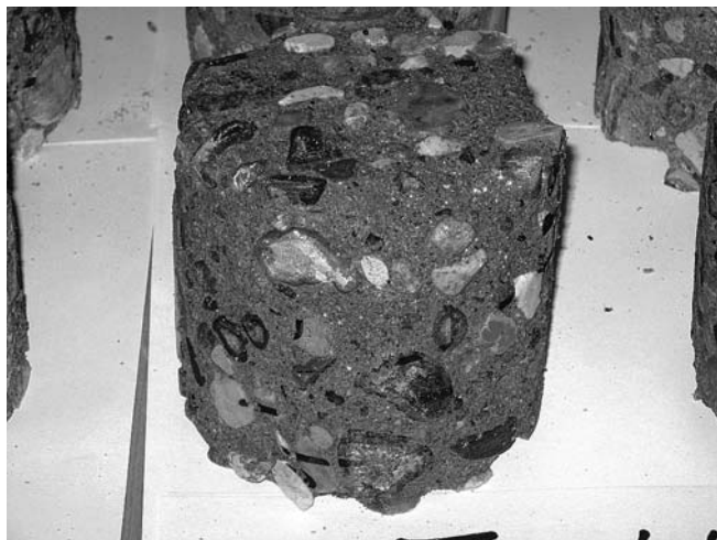
Рис. 5. Внешний вид образца, снятого с испытаний на морозостойкость: ребра округлены, оголен крупный заполнитель
