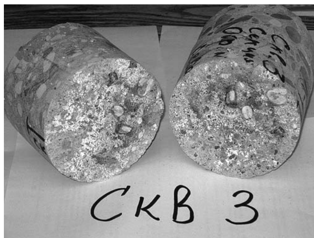
Рис. 4. Сквжина № 3, высолы на контакте наружного слоя (плиты-оболочки) и монолитного бетона
