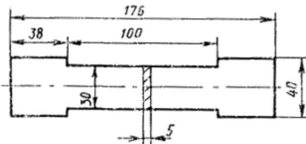
2. Заготовку рихтуют и шлифуют на глубину 0,2 - 0,3 мм. Параметр шероховатости поверхности  $R_a \leq 1,6$  мкм по ГОСТ 2789-73.
