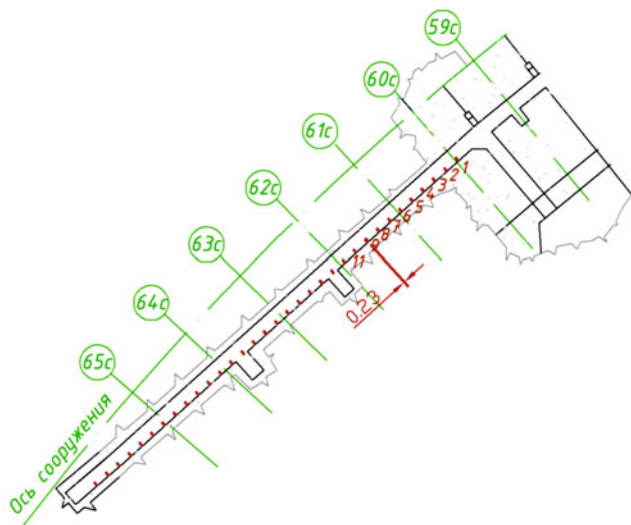
Рис. 6. Правобережная штольня отм. 467 м. Марки для измерения 3-метровым жезлом
