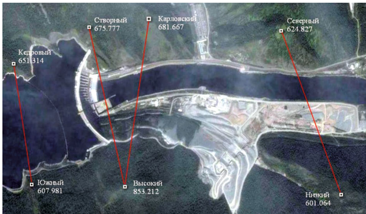
Рис. 4. Схема измерений линий между пунктами внешней опорной сети
