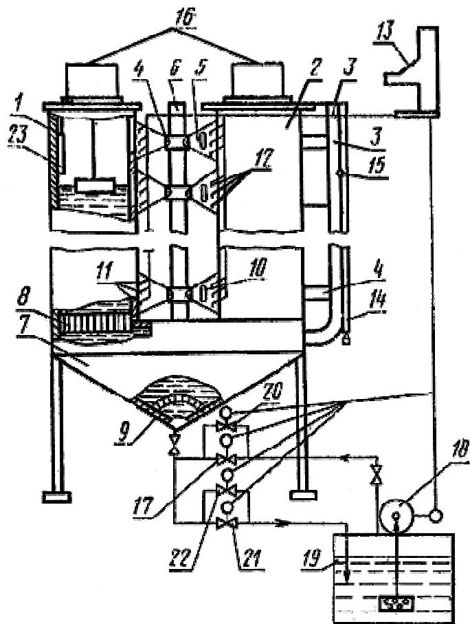
1.2. Гидравлическая часть установки содержит две измерительные трубы 1 и 2 и указательную трубку 3, которые соединены между собой через равные интервалы по высоте полыми трубками 4. Трубки 4 снабжены конусообразными переходными секциями 5, ориентированными своими основаниями в сторону измерительных труб 1 и 2.
