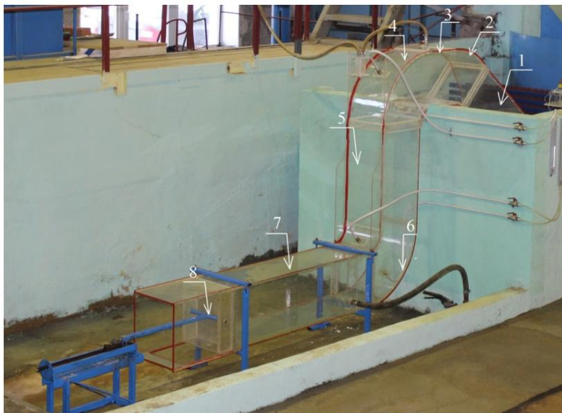
**Рис. 4.** Модель подводящего участка МГЭС с сифонным подводом:
