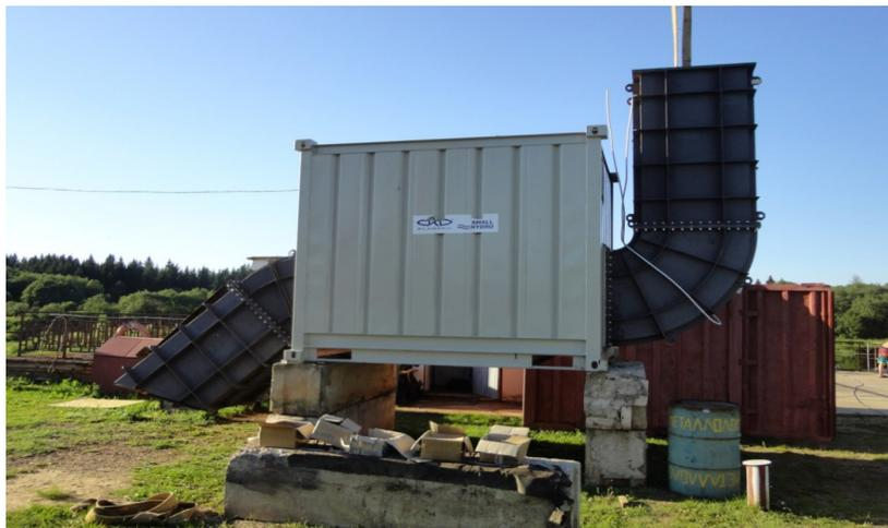
**Рис. 6.** Энергоблок мини-ГЭС в сборе с элементом подводящего и отводящим водоводами
