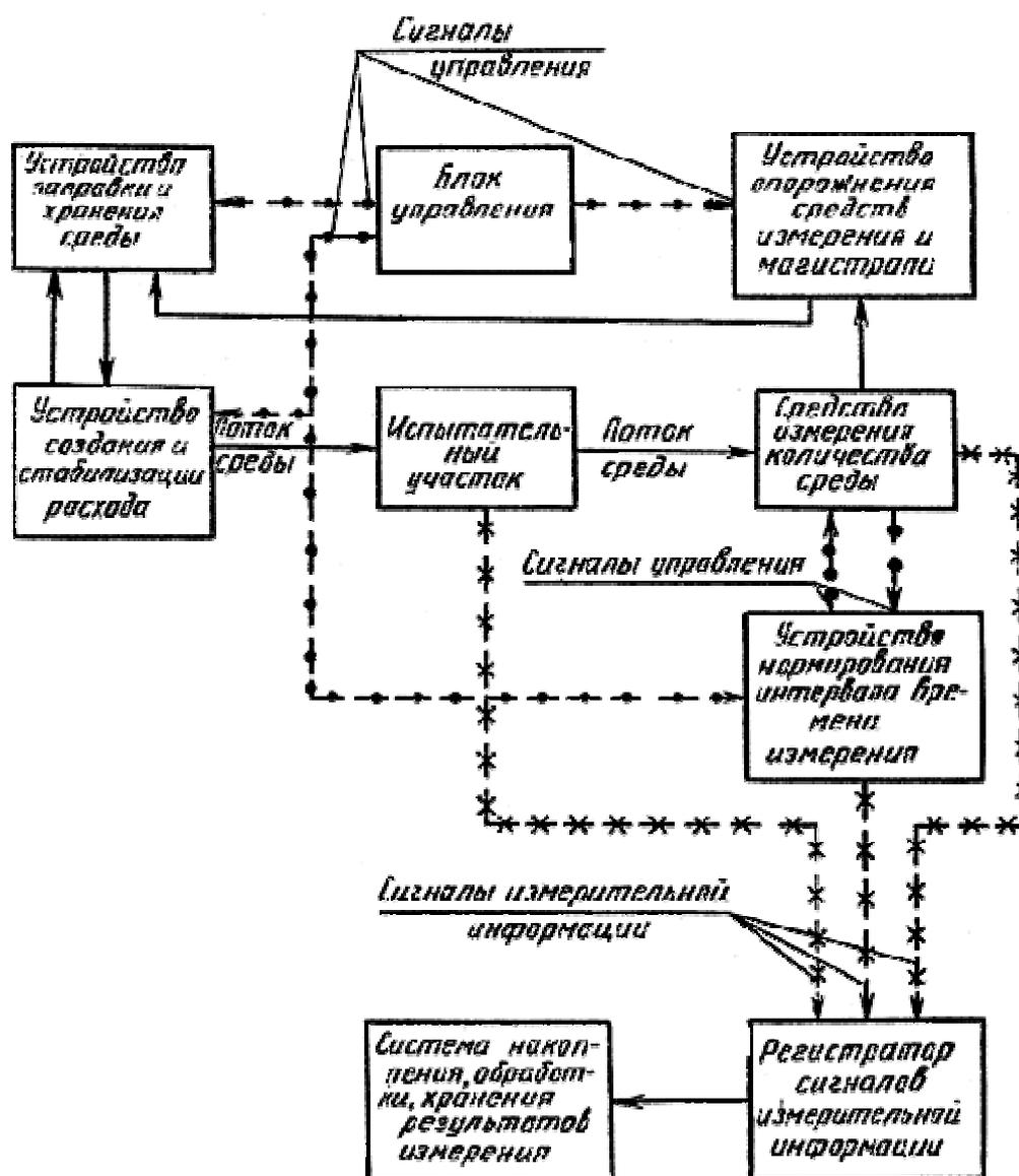
2. Поверочная расходомерная установка должна состоять из элементов, указанных в структурной схеме:
