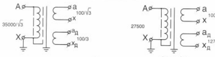
Рис. 5. Схемы трансформаторов ЗНОЛЭ
