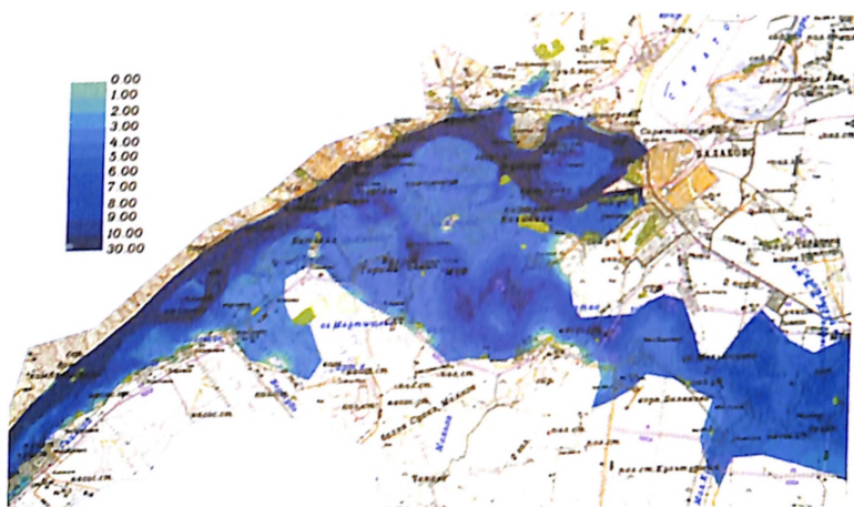
Глубины затопления в нижнем бьефе Саратовского гидроузла при расходе 70 000 м 3 /с (г. Балаково)
