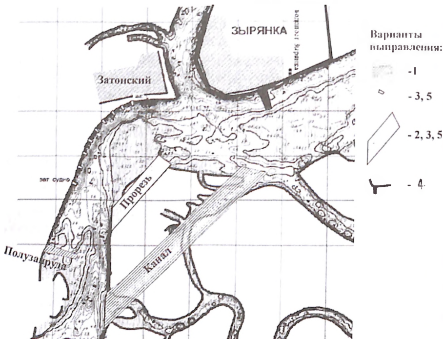
Рис. 4. Варианты выправления русла р.Колымы в районе пос.Зырян-ка, исследованные с помощью компьютерного моделирования: 1 — при условии сооружения длинной незатопляемой полузапруды на гребне левобережного побочня и прокопа спрямляющего канала за островом; 2 — прорезь через вершину правобережного побочня напротив вогнутого размываемого берега; 3 — прорезь второго варианта и серия коротких полузапруд вдоль вогнутого размываемого берега; 4 — полузапруда (контршпора), защищающая берег основного поселка; 5 — полузапруда, предусмотренная четвертым вариантом, возведе-ние серии коротких полузапруд вдоль вогнутого размываемого берега и спрямляющая прорезь на правобережном побочне.
