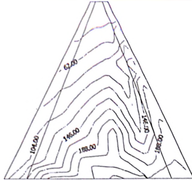
Рис. 5. Главные максимальные напряжения \sigma_1 (т/м 2 ) в плотине Н=100 м (откосы 0,5/1) от A_g = 0,2 g
