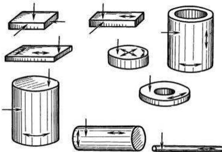
3.6. Контроль проводят путем сканирования преобразователем поверхностей поковок, определяемых заданной схемой прозвучивания.
