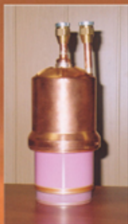
Внешний вид специального диода, изготовленного для проекта. Верхняя часть его представляет собой бачок водяного охлаждения.
