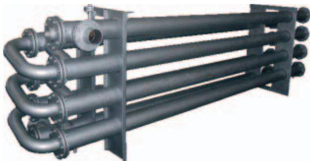
Если одним из теплоносителей является насыщенный пар, то его, как правило, направляют в межтрубное (кольцевое) пространство. Такие теплообменники часто применяют как жидкостные или газожидкостные. Подбором диаметров внутренней и наружной труб можно обеспечить обеим рабочим средам, участвующим в теплообмене, необходимую скорость для достижения высокой интенсивности теплообмена.
