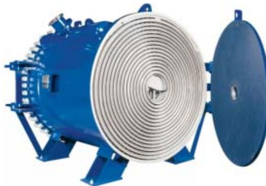
Если материал прокладки разрушается одним из теплоносителей, то один канал заваривают с обеих сторон («глухой» канал), а другой уплотняют плоской прокладкой. При этом «глухой» канал недоступен для механической очистки.
