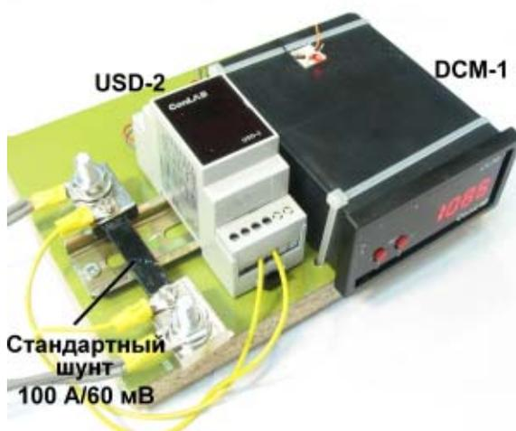
**Рис. 5. Макет устройства для мониторинга целостности цепи подстанционной батареи, выполненный на базе стандартного шунта и электронных преобразователей компании Conlab (Израиль); USD-2 — электронный преобразователь входного сигнала  $\pm 200$  мкВ в выходной сигнал 4—20 мА; DCM-1 — микроконтроллер**
