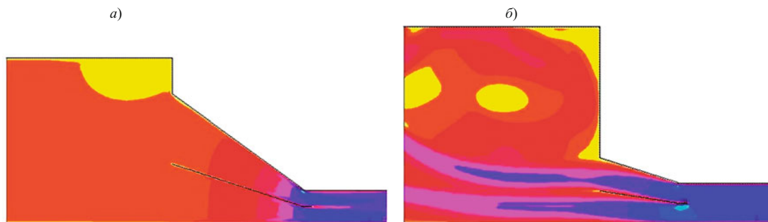
Рис. 7. Примеры результатов расчета водоприемника с одним разделителем потока: a — турбинный режим, L = 4H , \beta = 36^\circ ; б — насосный режим, L = 2H , \beta = 18^\circ
