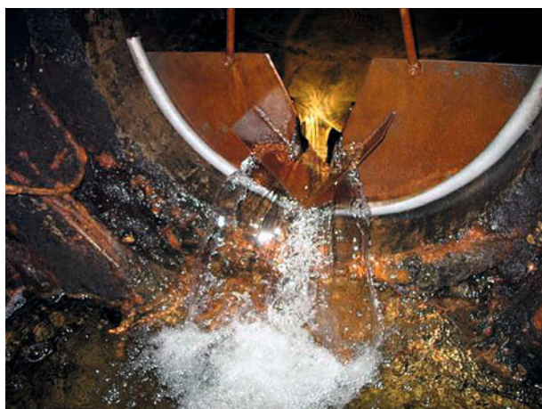
Рис. 3, д. Измерительный водослив с тонкой стенкой, установленный в устье участка дренажного коллектора
