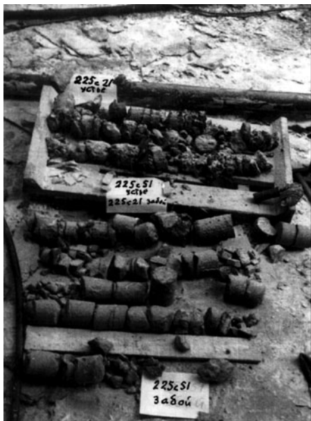
Рис. 2. Состояние керна долерита из скважины в секции 25
