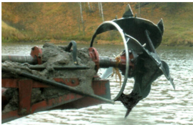
Рис. 5. Фрезерный рыхлитель собственной конструкции
