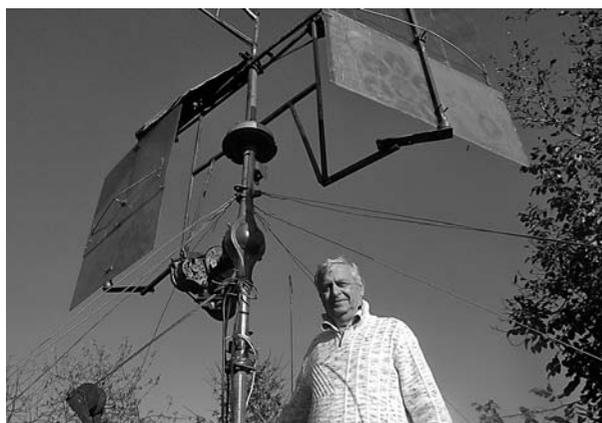
Рис. 9. Малая карусельная парусная ВЭУ с синхронным управлением парусов, реализованная автором
