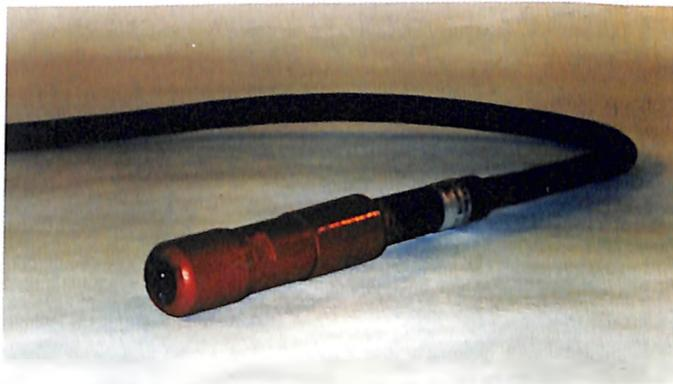
Преобразователь порового давления ПДС
