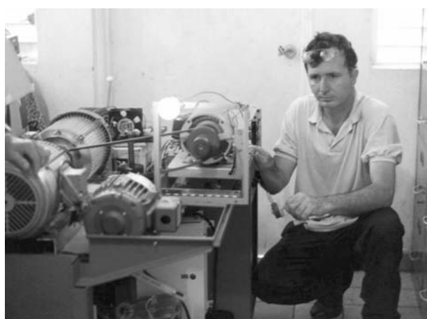
Вращающийся преобразователь "RotoVerter"
