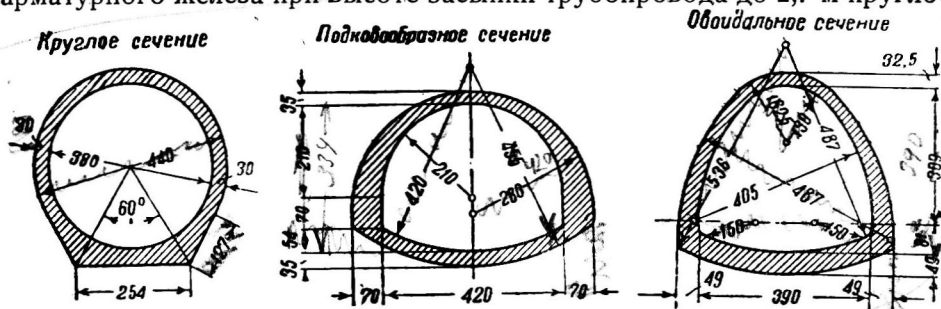
Фиг. 39. Варианты сечения трубопроводов.
