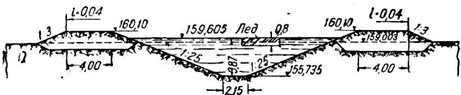
Фиг. 30. Поперечное сечение запасной ветви канала на км 4 + 200.
