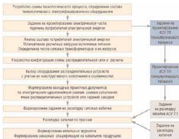
Рис. 1. Блок-схема последовательности проектных процедур при проектировании электрической части промышленного объекта
