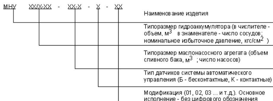
Пример условного обозначения масляной установки объемом гидроаккумулятора 25 м<sup>3</sup>, состоящего из 2 сосудов, с номинальным избыточным давлением 4 МПа (40 кгс/см<sup>2</sup>, объемом сливного бака масляного насосного агрегата 32 м<sup>3</sup> с 3 насосами, с автоматическим управлением на бесконтактных датчиках основного исполнения:
