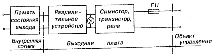
Рис. 9.6. Структурная схема двоичного выхода программируемого контроллера
