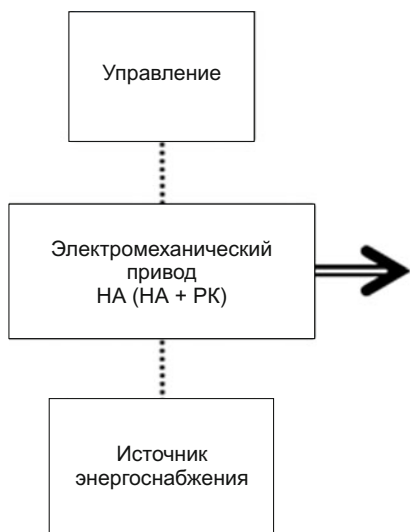
Рис. 4. Структурная схема управления направляющего аппарата и рабочего колеса гидротурбины с использованием электро-механического привода
